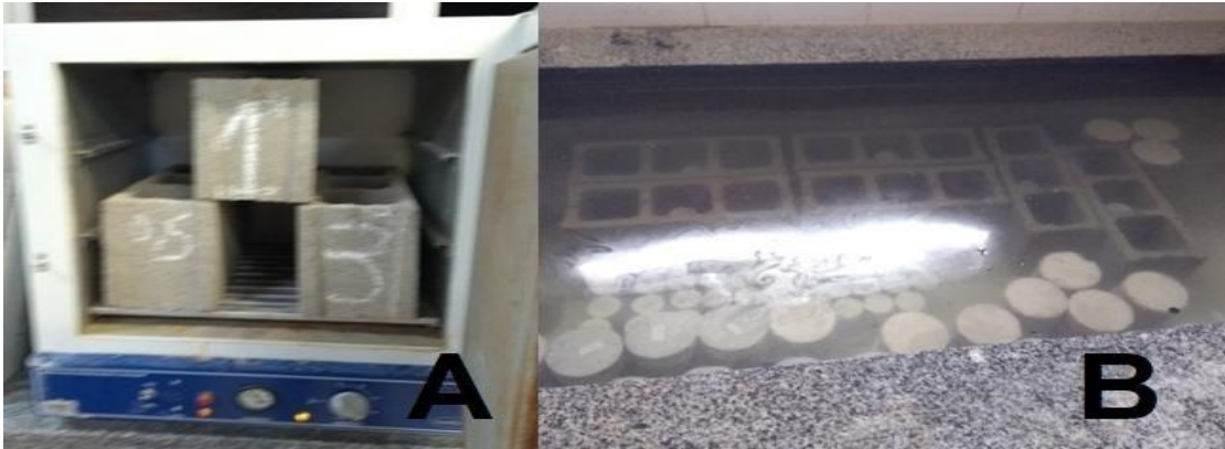
Figura 3 - Blocos em estufa (A) e imersos em água (B) Fonte: Os autores.
