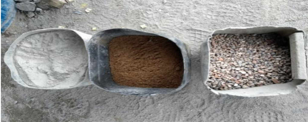
Figura 1 - Cimento, areia e brita reciclada Fonte: Os autores.
